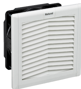
CONJUNTO VENT. C/ FILTRO 320X320MM/291X291MM 1000-1150M3/H IP54 Cód. NTSFF322V
